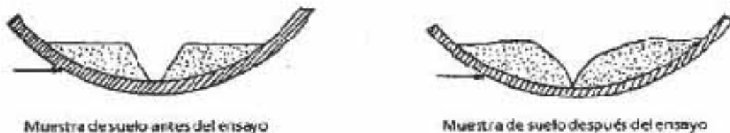
Figura 3. Diagrama ilustrativo del ensayo de límite líquido.
